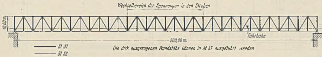
Abb. 5. Stahl 37 für nicht ausgenutzte Stabquerschnitte eines Fachwerkes.
