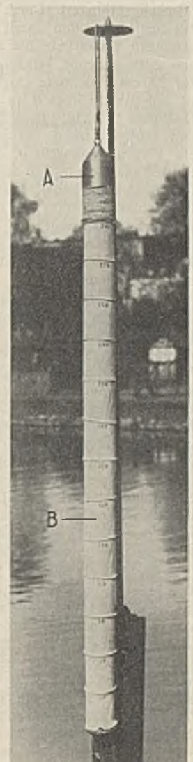
Abb. 2. Schwimmer mit ausgezogenem Schlauch.
