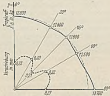
Abb. 7. Der Einfluß des schrägen Kraftangriffes auf die Verschiebung unter der Gebrauchslast und auf die Bruchlast bei den Körpern mit Krallenband und Klemmnägeln.
