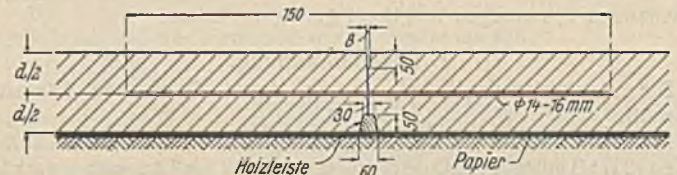
Abb. 5. Scheinlängsfuge mit Rundeseisenanker.
