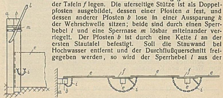
Sperrnase *m* herausgezogen und damit der Pfosten *b* seines Haltes beraubt, legt sich unter dem Druck des Wassers um und entzieht der ersten Stautafel *e* das uferseitige Widerlager, wodurch der Pfosten *b* und die Tafel *e* mitgerissen werden und der hinter der Tafel *f* liegende Kies nachstürzt. Hierbei geben die Tafel *f* und die Tafel *e* der folgenden Öffnung dem Druck des Wassers nach und schwimmen gemeinschaftlich durch die zweite Öffnung ab.
