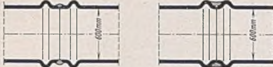
Abb. 5. Schweißverbindungen der Hauptleitungen.
