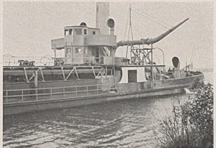
Abb. 12. Spülrohr im abgeklappten Zustande, spritzfertig.
