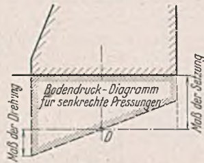
Abb. 6. Bodendrücke und Bewegungen in der Bodenfuge.
