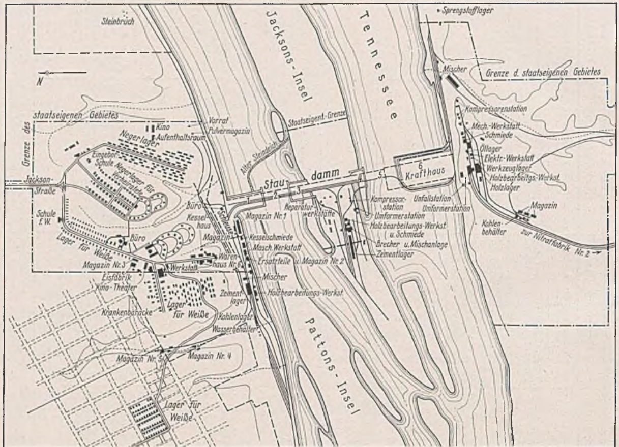
Abb. 5. Die Baustellenanordnung des Wilson Dam.
