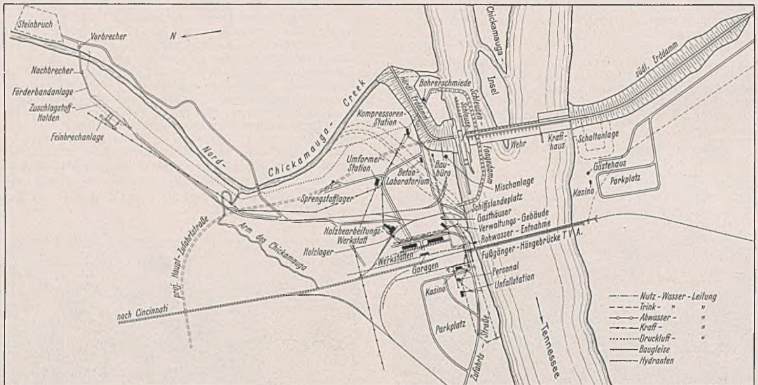
Abb. 24. Die Bauernrichtung des Chickamauga Dam.
