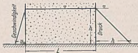
Abb. 3. Druck- und Geschwindigkeitsverteilung bei waagrechtem Fließen des obersten und untersten Wasserfadens.
