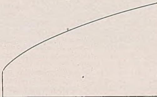
Abb. 5. Form der Spiegellinie nach Gl. (80) für n=1 bzw. Gl. (81) für \cos \varphi = \frac{y}{p_0} .
