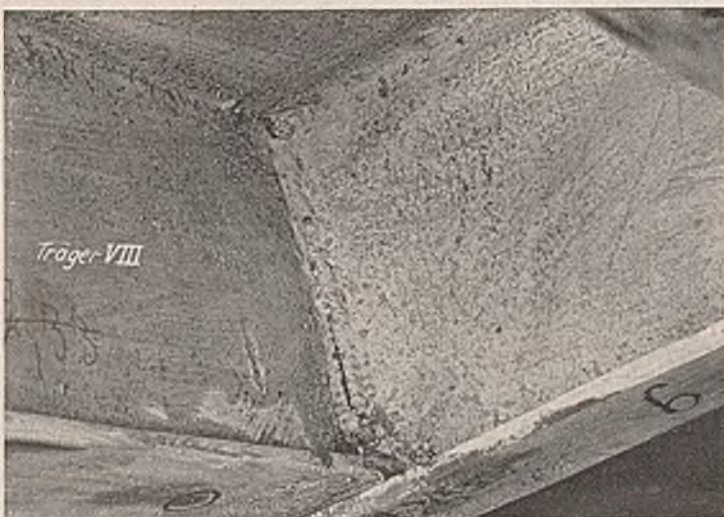
Abb. 11. Riß in der Schweißnaht bei Platte A_3 .
