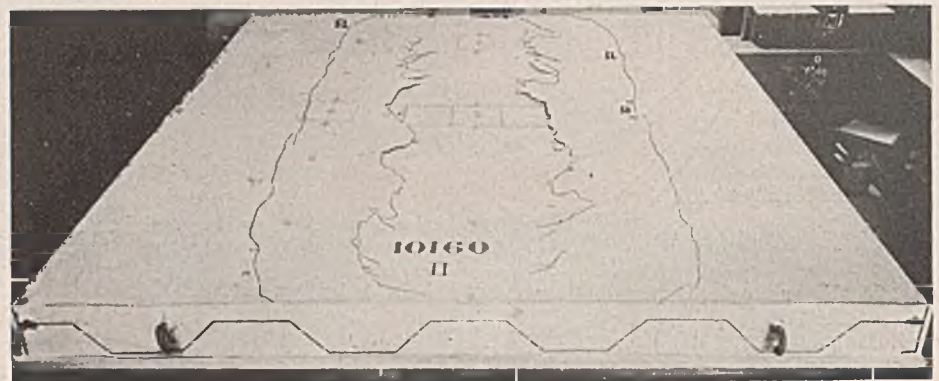
Abb. 28. Durchbruch des Füllbetons.
