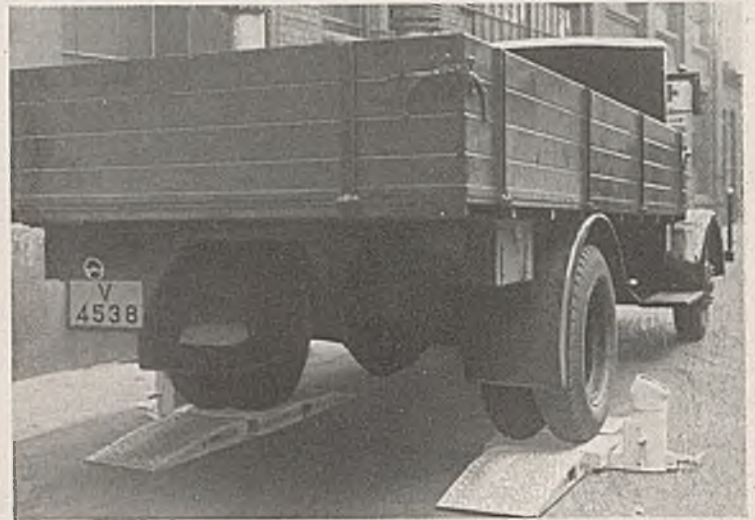
Abb. 1. Ortsveränderliche Waage zum Messen der Raddrücke von Lastkraftwagen. (Bauart Vomag-Betriebs AG.)
