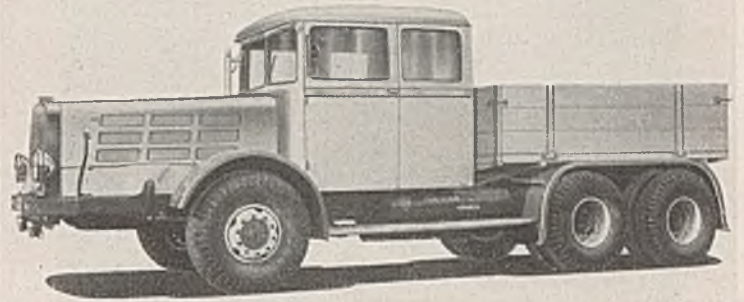
Abb. 11. Schlepper mit 170-PS-Dieselmotor für schwerste Anhängelasten. Faunwerke.
