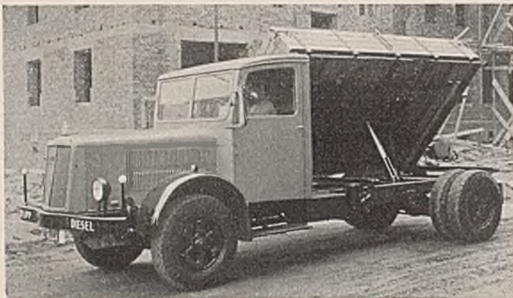
Abb. 4. Dreiseitenkipper-Lastkraftwagen mit seitlich gekipptem Lastträger. Leistung des Dieselmotors (Junkers) 90 PS. (Fried. Krupp.)
