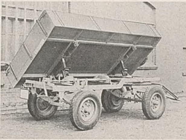
Abb. 19. Kippanhänger mit Zahnstangen-Kippgetriebe und Handkurbel an der Rückseite. 3,5 t Nutzlast. Steinfurt.
