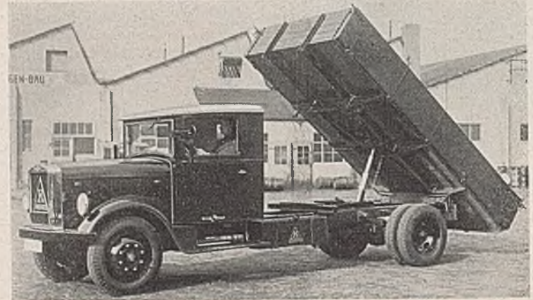
Abb. 5. Dreiseitenkipper-Lastkraftwagen in der Stellung als Hinterkipper. Hansa-Lloyd.
