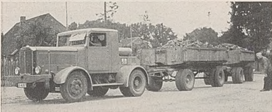
Abb. 9. 100-PS-Diesel-Eilschlepper mit Sechszylindermotor. Hanomag.
