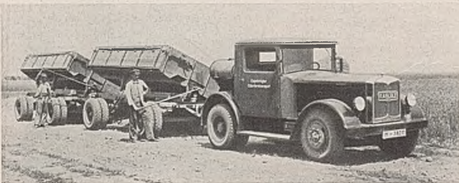
Abb. 10. 130-PS-Zugmaschine für Fahrgeschwindigkeiten bis 50 km/h. 5 Vorwärts-Getriebegänge. Hydraulisches Kippgetriebe der Anhänger (Kaelble).
