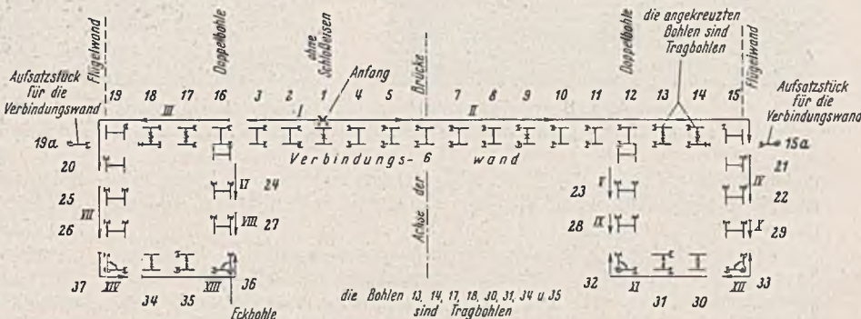
Abb. 6. Rammplan der Peiner Kastenspundbohlen für die Widerlager.
