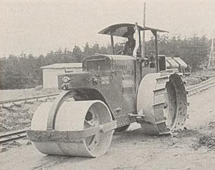
Abb. 3. Dreiradwalze mit Verbreiterungsringen und Greifern an den Hinterrädern zum Verringern des spezifischen Druckes.
