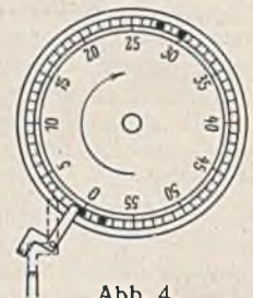
Abb. 4. Elektrische Synchronuhr für das Ein- und Ausschalten der Schlammförderpumpe.
