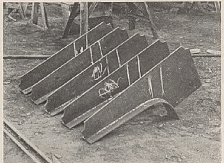
Abb. 10. Ansätze fertig geschweißt.
