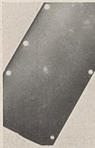
Abb. 5. Fehlstelle im Röntgenbild.
