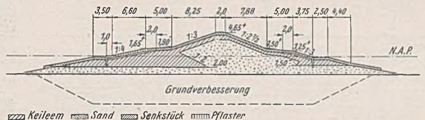
Abb. 3. Querschnitt des Seedeichs bei der Insel Urk.
