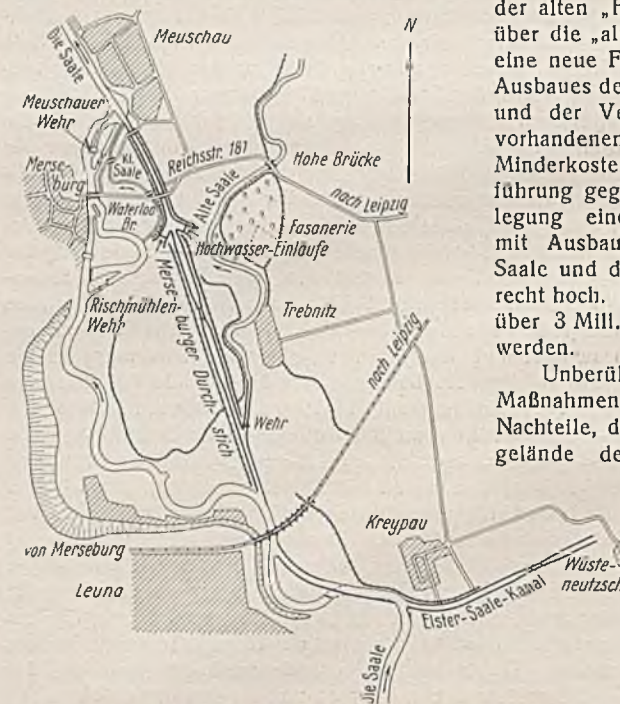
Abb. 3. Ausführung mit Hochwassereinläufen.
