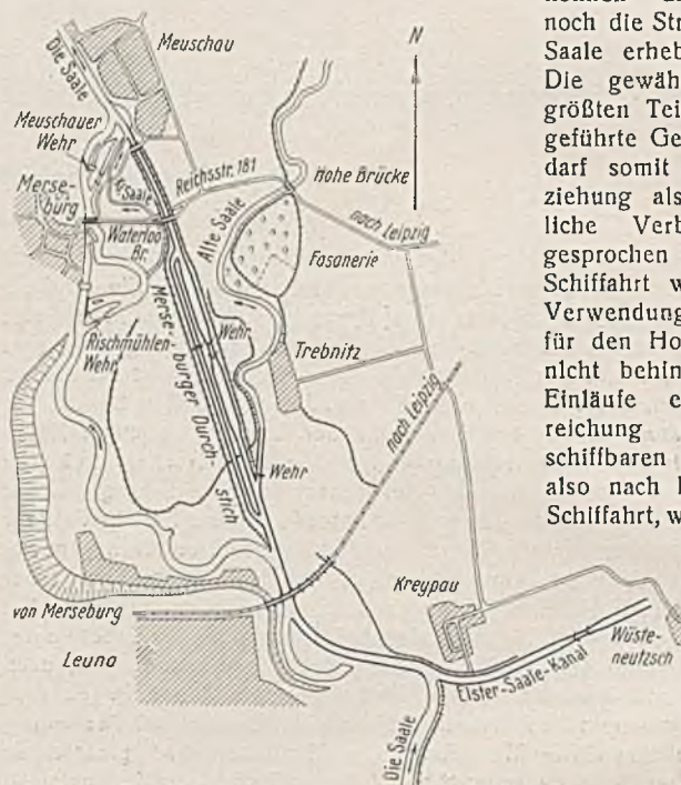
Abb. 2. Ausführung mit Wehrkanal.
