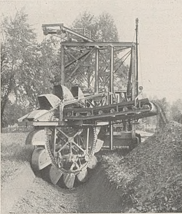
Abb. 5. Buckeye-Schaufelradgrabenbagger in Sonderbauart mit schwenkbaren Leiter zur Herstellung von Gräben mit halbkreisförmigem Querschnitt.
