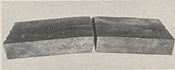
Abb. 8. Schweißraupenbiegeprobe St 52, 50 mm dick, geprüft im Walzzustande.
