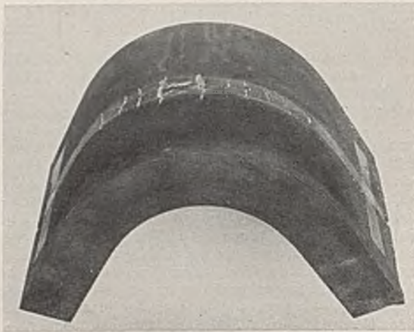
Abb. 9. Schweißraupenbiegeprobe St 52, 50 mm dick, geprüft im normalgeglühten Zustande.
