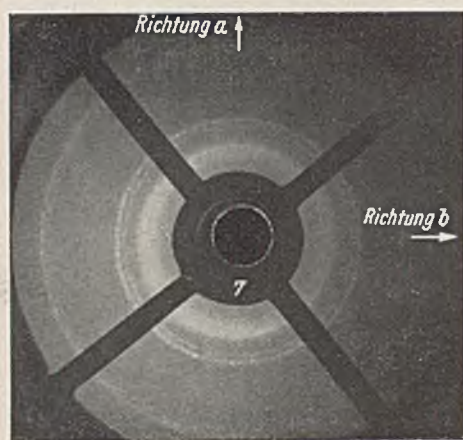
Abb. 9. Rückstrahlendiagramm unter 45° zur Stabachse angestrahlt.
