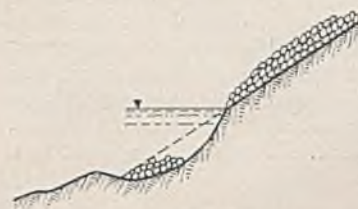
Abb. 5. Böschung im Abbruch.
