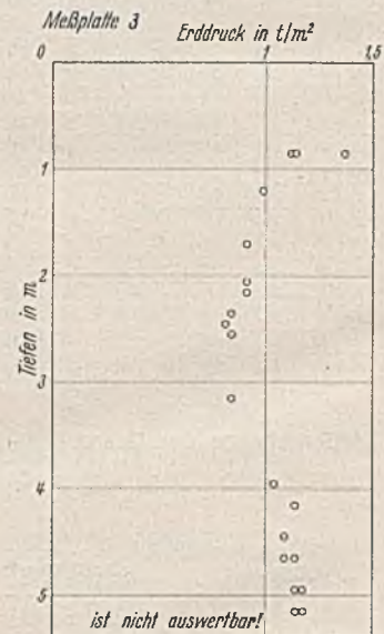
Abb. 20b. Ausmittlung der Meßergebnisse der Reibungsplatte 3. (Dieses Ergebnis ist nicht auswertbar).
