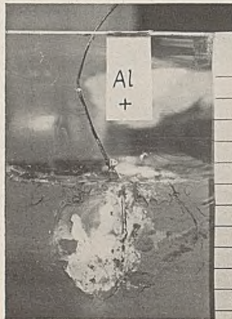
Abb. 1. Ablagerung unlöslicher Al-Salze im Boden.
