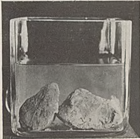
Abb. 2. Elektrochemisch verfestigter Ton nach 3 1/2 jähriger Wasserlagerung.
