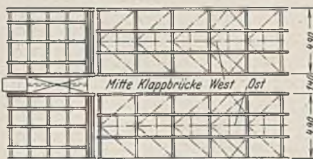
Abb. 1. Ansicht und Grundriß der Peeneklappbrücke Anklam.
