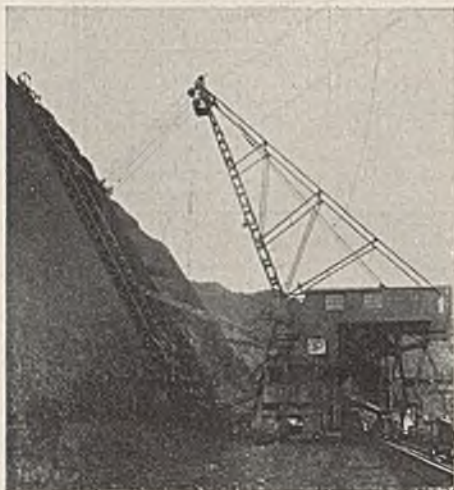
Abb. 2. Derselbe Bagger wie auf Abb. 1 nach dem Umbau mit einem Raupenfahrwerk. Bauart Lübecker M.-G.
