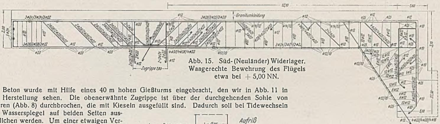
Abb. 15. Süd- (Neuländer) Widerlager. Waagerechte Bewehrung des Flügels etwa bei + 5,00 NN.
