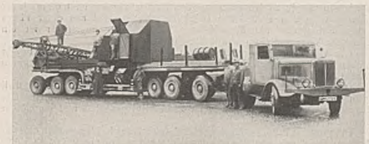
Niederplattformwagen für Nutzlasten bis 40 t. Bauart F. X. Meiller.
