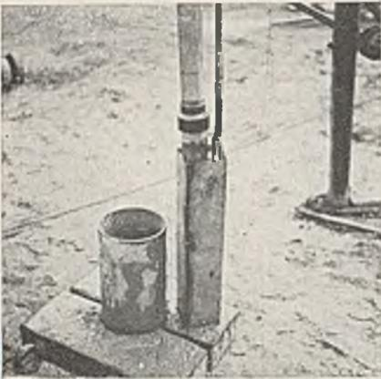
Abb. 12. Hauptgerät mit Zusatzgerät nach Entnahme einer Probe.
