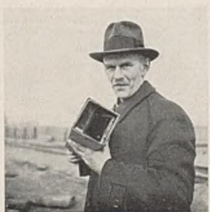
Abb. 11. Zusatzgerät für nichtbindigen Boden von unten gesehen, Klappe geöffnet.
