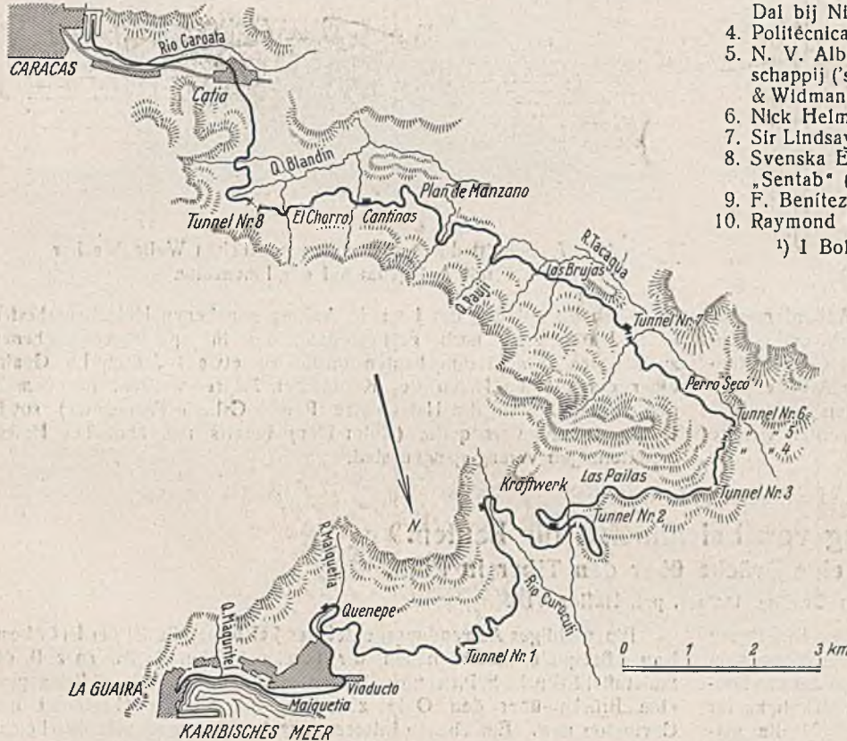
Abb. 3. Linienführung der Verbindungsbahn (37 km lang) von La Guaira nach der Hauptstadt Caracas durch das Küstengebirge (Höhenunterschied über 1000 m).
