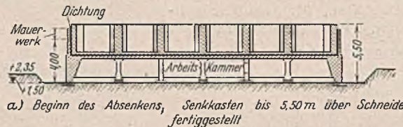
a.) Beginn des Absenkens, Senkkasten bis 5,50 m über Schneide fertiggestellt
