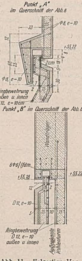
Abb. 11. Falzartige Verbindung am Löschschlot.
