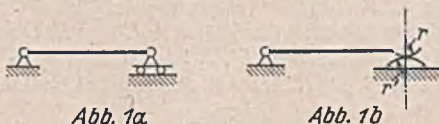
Abb. 1a. Dreigelenkbogen mit unendlich langem Glied. Abb. 1b. Dreigelenkbogen mit Ersatz eines Gliedes durch ein Krümmungspaar.
