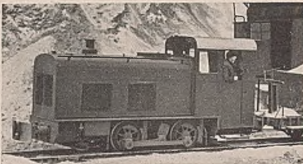
Abb. 11. 12-t-Diesellokomotive (A 3 M 420) mit einem 75-PS-Motor (Deutz).
