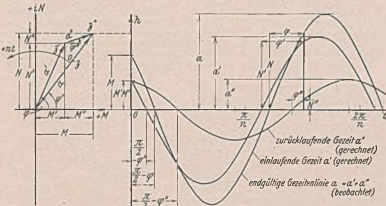
Abb. 14. Zusammensetzung einer Gezeitenlinie (a) aus den Wasserständen der einlaufenden (a') und der zurücklaufenden (a'') Welle als Linie und als Vektor.
