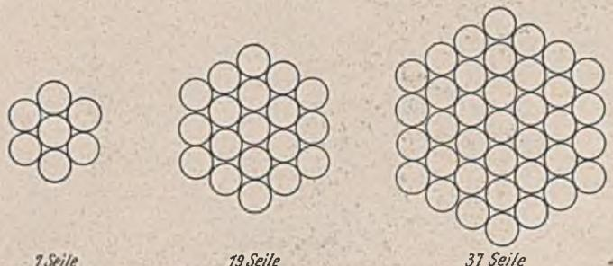
Abb. 74. Sechseckige Kabel aus runden Seilen mit gleichem Durchmesser.
