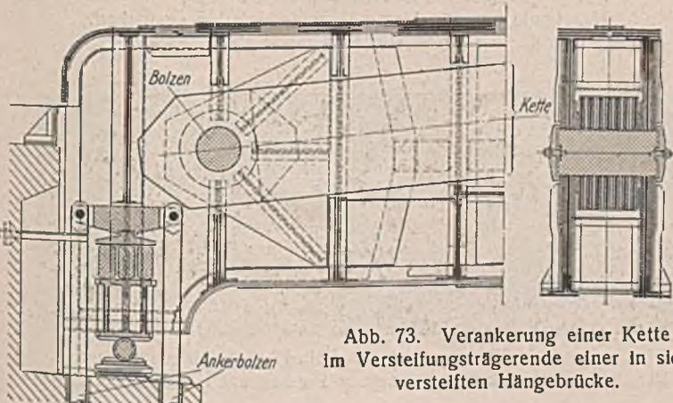
Abb. 73. Verankerung einer Kette im Versteifungsträgerende einer in sich versteiften Hängebrücke.
