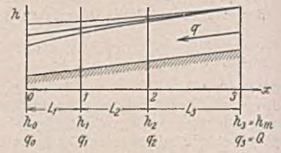
Abb. 8. Randbedingungen bei drei Flußabschnitten zwischen Flutgrenze und Mündung.
