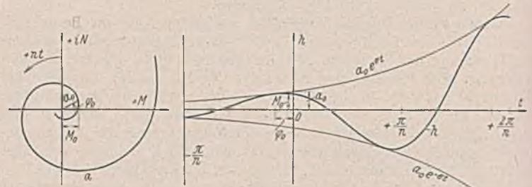
Abb. 2. Darstellung einer Sturmflutlinie als aufgeschaukelte cos-Linie und als in einer Spirale laufender Vektor nach Gl. (1d), (1e).
