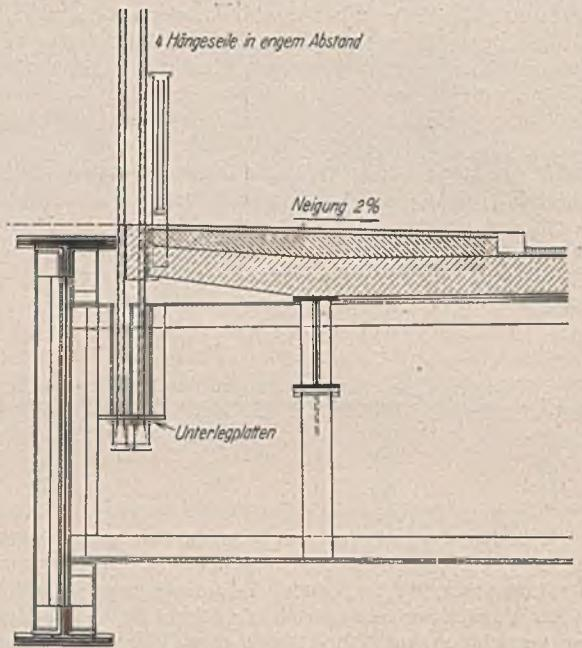
Abb. 92. Aufhängung am Querträger hinter dem Versteifungsträger.
