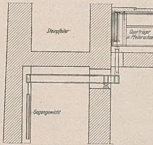
Abb. 91. Senkbare Lagerung des durchlaufenden Versteifungsträgers am Turmpfeiler mit Gegengewicht-Hebel zur Aufhebung des Eigengewichtes des Querträgerfeldes am Pfeiler (Vorschlag Leonhardi).
