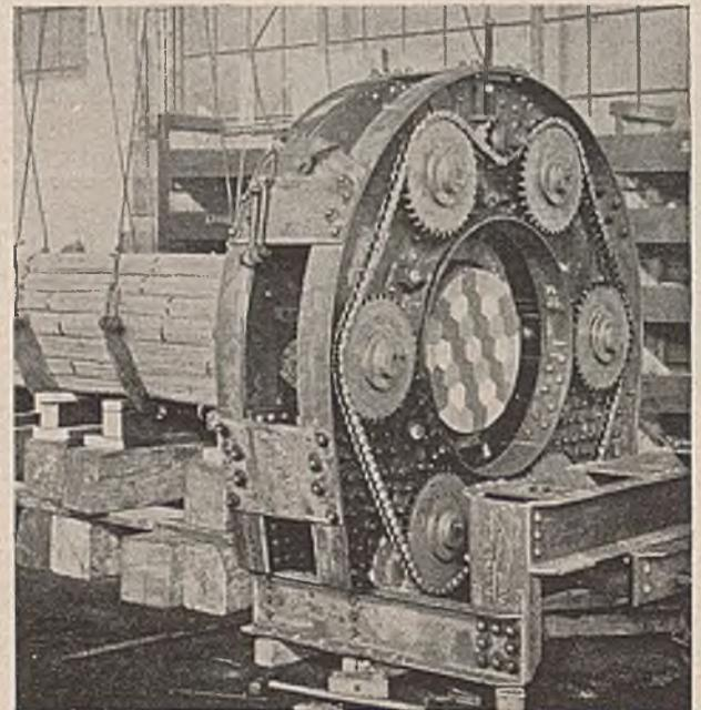
Abb. 77a. Probestück eines Paralleldrahtkabels in der später am Bau verwendeten Presse; Kabelende gepreßt, Litzen verschiedenfarbig gestrichen.
