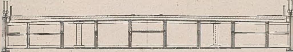
Abb. 88. Querschnitt einer Hängebrücke mit vollwandigen Versteifungsträgern, Fahrbahn am Obergurt, Deckbrücke, Gehweg innerhalb der Aufhängung.
