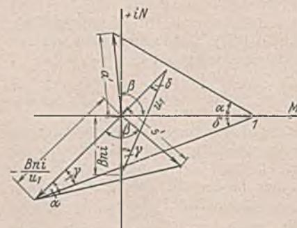
Abb. 18. Zusammenhang zwischen den Vektoren  $-B n i, u_1, a'$  und  $s'$ .
