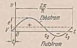
Abb. 6. Strömungsbild unterhalb der Flutstromgrenze. In einem Tidestrom überwiegt die Ebbestromung.
