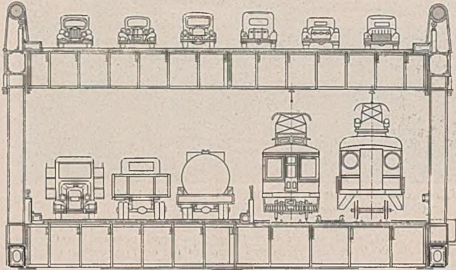
Abb. 99. Querschnitt der San Francisco Bay-Brücke.
