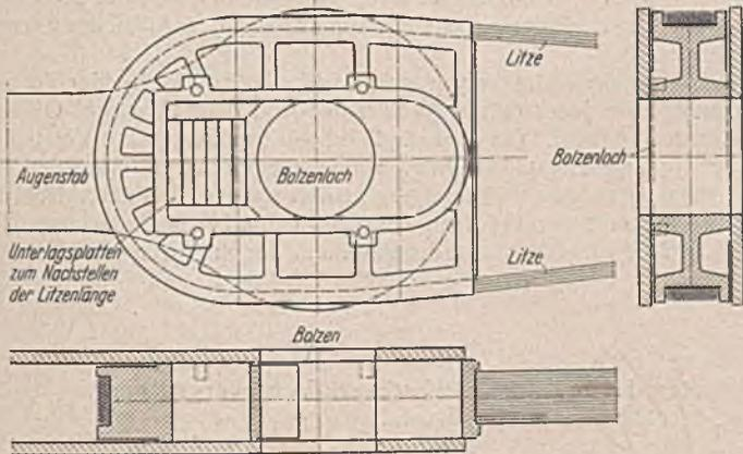
Abb. 80. Litzenschuh für luftgesponnene Paralleldrahtkabel (amerikanische Bauart).
