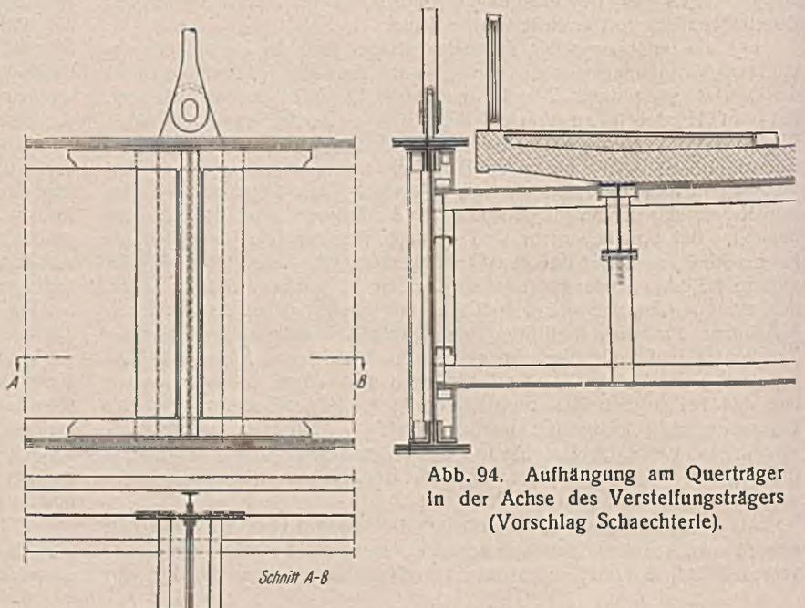
Abb. 94. Aufhängung am Querträger in der Achse des Versteifungsträgers (Vorschlag Schaechterle).
