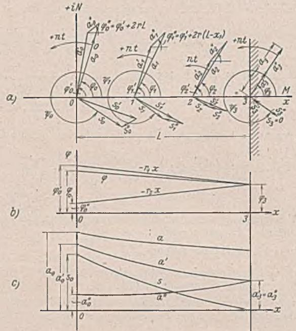
Abb. 17. Vollständiges Zurückwerfen einer Welle in einem gleichbleibenden Kanal an einer senkrechten Wand in Vektordarstellung.
