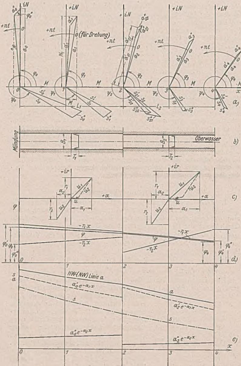
Abb. 15. Gesamtverlauf der Gezeit in zwei Abschnitten einer Flußmündung, dargestellt durch Vektoren.
