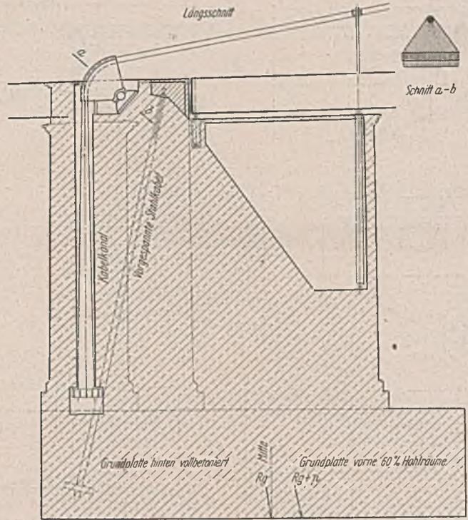
Abb. 105. Verankerung eines stellen Kabels im Fels (George Washington-Brücke, New York).
