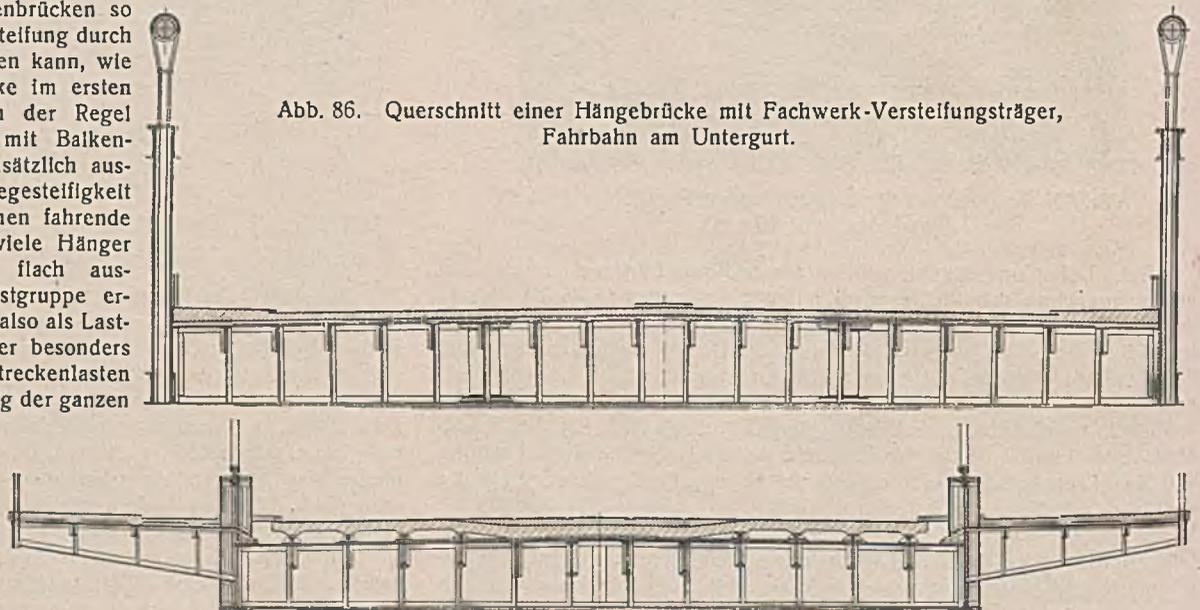
Abb. 87. Querschnitt einer Hängebrücke mit vollwandigen Versteifungsträgern, Fahrbahn zwischen den Gurten, Trogbrücke, Gehweg ausgekragt.
