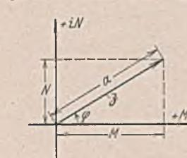
Abb. 13. Darstellung des Ausdrucks  $M + iN = a \cdot \cos \varphi + i a \cdot \sin \varphi = \zeta$  als Vektor für die Gezeitenlinie.
