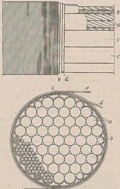
Abb. 75. Rundes Kabel aus Litzenseilen (amerikanische Bauart).
