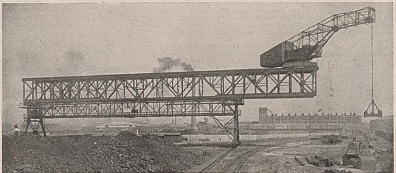
Abb. 1. Verladebrücke mit Verschiebeträger und oben laufendem Drehkran von 7,5 t und 15 t Tragkraft bei 17 m und 10 m Ausladung; Brückenstützweite 58 m; Verschiebewege beiderseits 17,6 m, durch Endpuffer begrenzt.
