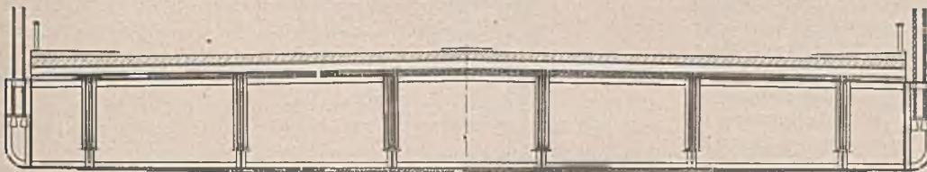
Abb. 89. Querschnitt einer Hängebrücke mit Trägerrostversteifung, Deckbrücke.
