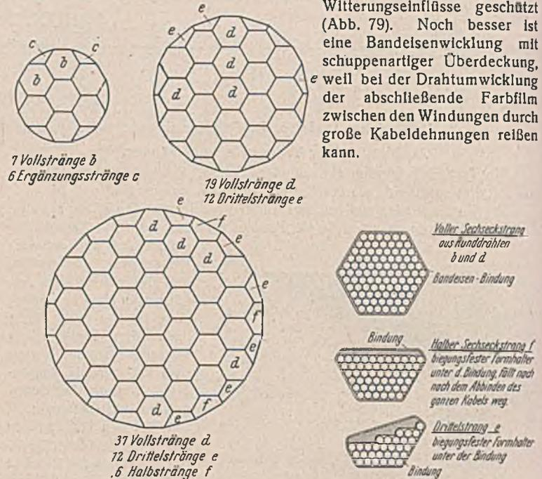
Abb. 78. Rundes Paralleldrahtkabel aus sechseckigen Litzen mit ErgänzungsLitzen am Rand (Vorschlag Leonhardt).
