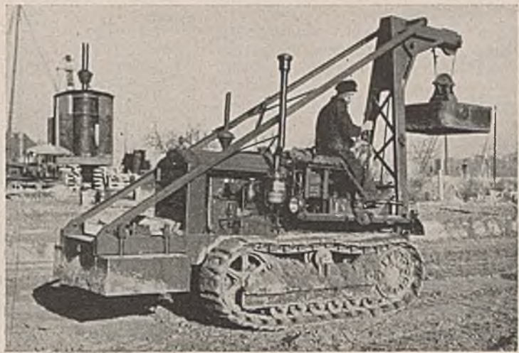
Abb. 22. Raupenschlepper mit Stampfausrüstung (Hanomag).
