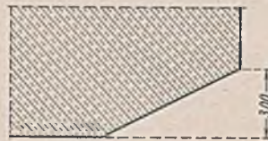
Abb. 18. Abschrägen der Bauwerkssohle.
