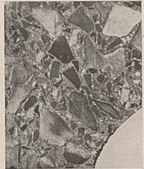
Abb. 8. Hochwertiger Rüttelbeton. Zementgehalt 292 kg/m 3 , Sandgehalt 40%, Biegezugfestigkeit nach 28 Tagen 83 kg/cm 2 , Druckfestigkeit nach 42 Tagen 624 kg/cm 2 .
