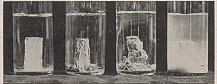
Abb. 20. Zerfallen verschiedener Tone und Böden nach 15 min Lagerung in Leitungswasser (vgl. Zahlentafel 4).
