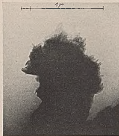
Abb. 3. Deutscher Ca-Bentonit, eingetrocknetes Ultrazentrifugat. Vergrößerung 1:37 000.
