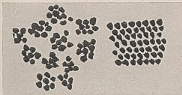
Abb. 6. Krümelgefüge von Tonböden, eine Wirkung von Al-, Fe-, Ca-Ionen auf Ton. Abb. 7. Einzelkorngefüge von Na-Ton. Abb. 6 u. 7 nach P allmann.
