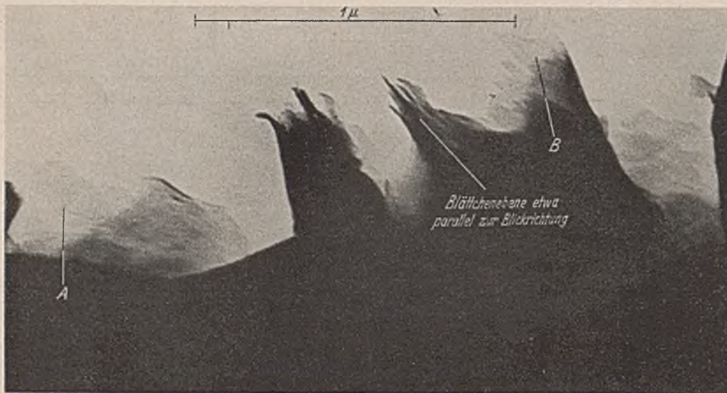
Abb. 4. Freil in den Strahlengang hineinragendes Randstück von amerikanischem Na-Bentonit mit feinsten, an der Grenze der Wahrnehmbarkeit liegenden, zum Teil etwa 1 \text{ m}\mu dicken Blättchen. An der mit A gekennzeichneten Stelle wird zum ersten Male ein einzelnes Elementarschichtpaket sichtbar. Vergrößerung 1:60 000.
