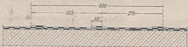
Abb. 16. Klebnaht 325 mm bei 600 mm breiter Blechbahn.
