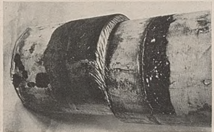
Abb. 31. Prüfung der Blechbanddichtung an einem Versuchskörper auf Abscherung. Aussehen der Dichtung nach Entfernen der Schutzschicht. Die Blechdichtung war nach dem Versuch bei Prüfung unter 2 at Wasserüberdruck noch einwandfrei dicht.
