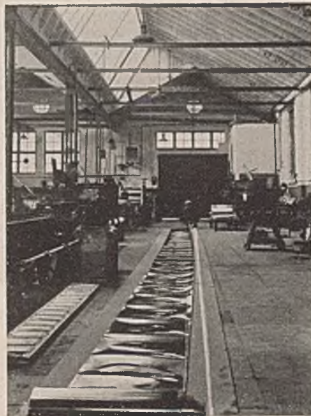
Abb. 4. Abgerolltes, ungerücktes, handelsübliches Blechband aus dünnem Kupfer. Wellig und krumm. Für Dichtungszwecke vollkommen ungeeignet.
