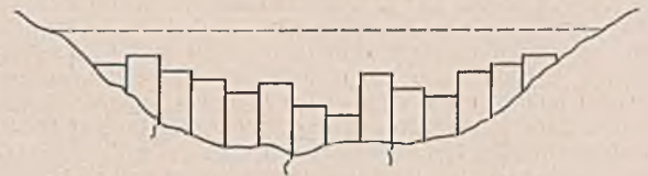
Abb. 19c. Betonieren der Sperrmauern in den Mauer Scheiben abgestuft.
