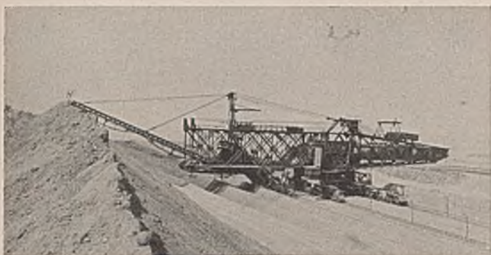
Abb. 26. Uihlein-Absetzer für wahlweise Hoch- und Tiefschüttung mit um 360° schwenkbarem Oberbau (als Hochschütter arbeitend).
