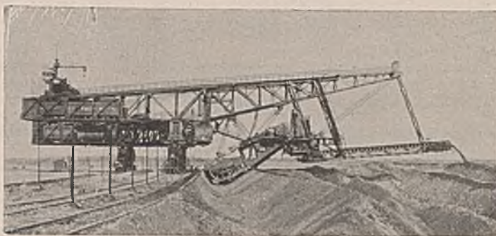
Abb. 25. Uihlein-Absetzer für Tiefschüttung mit Schwenkbarkeit des Oberbaues um je 40° aus der Mittellinie.
