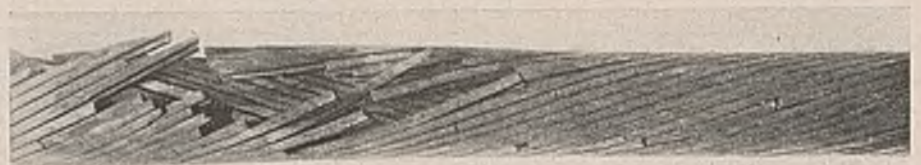
Abb. 13. Nahe dem Kopfgelegene Bruchstelle des Seils V 65 VS nach Wegnahme der äußersten Drahtlage.
