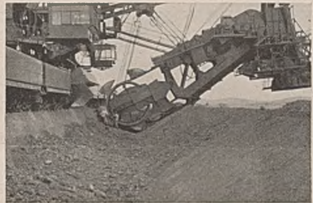
Abb. 31. Kippgraben eines Großabsetzers.
