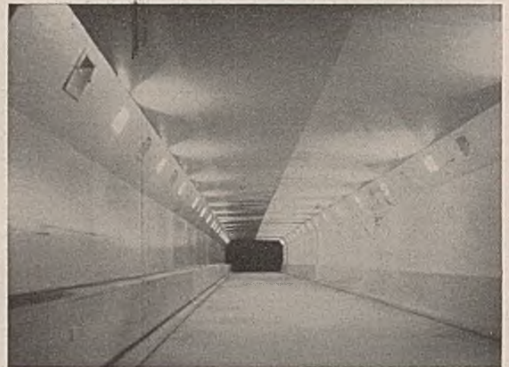
Abb. 20b. Lichte und dunkle Ringe im beleuchteten Tunnelmodell.
