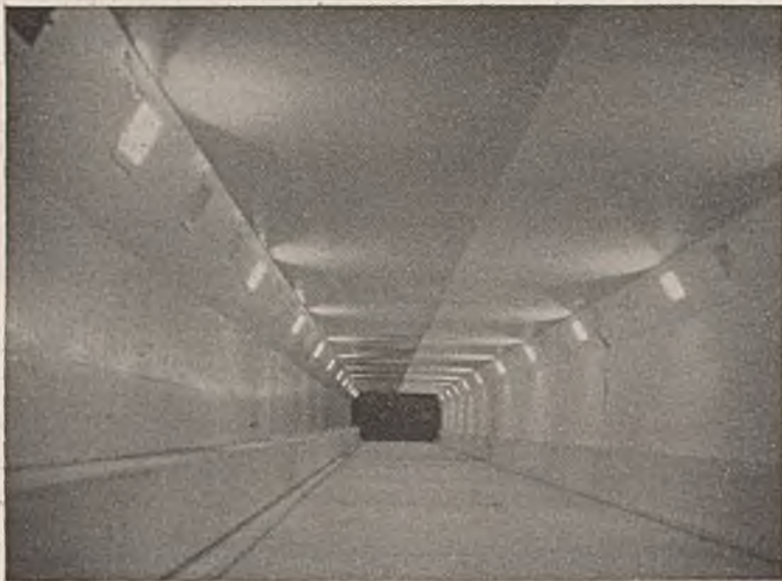
Abb. 20a. Gleichmäßige Belichtung des Tunnelmodells.
