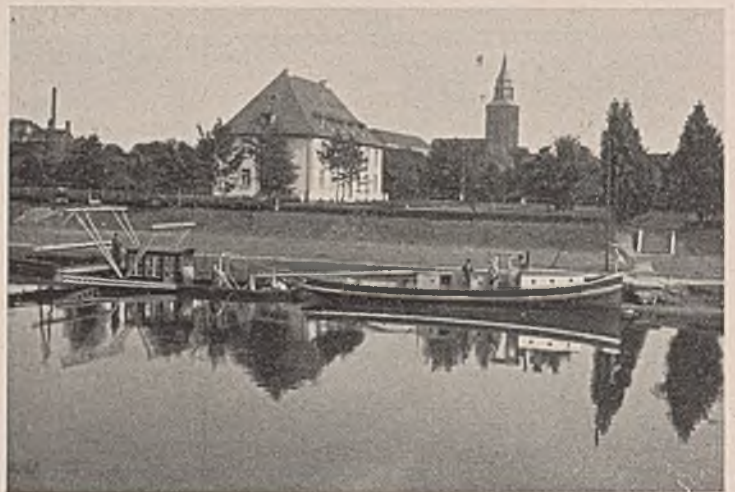
Abb. 8. Peilschiff im Schlepp eines Motorbootes.
