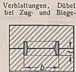
Abb. 20. Querschnittschwächung bei Ringdübeln.
