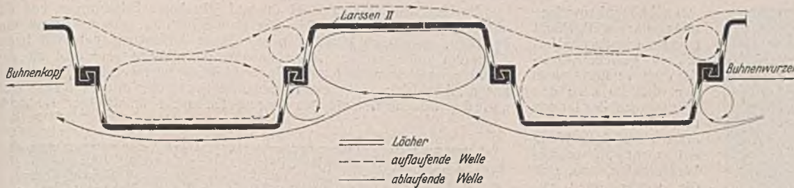
Abb. 18. Zerstörungerscheinungen durch Sandschliff bei auf- und ablaufenden Wellen.
