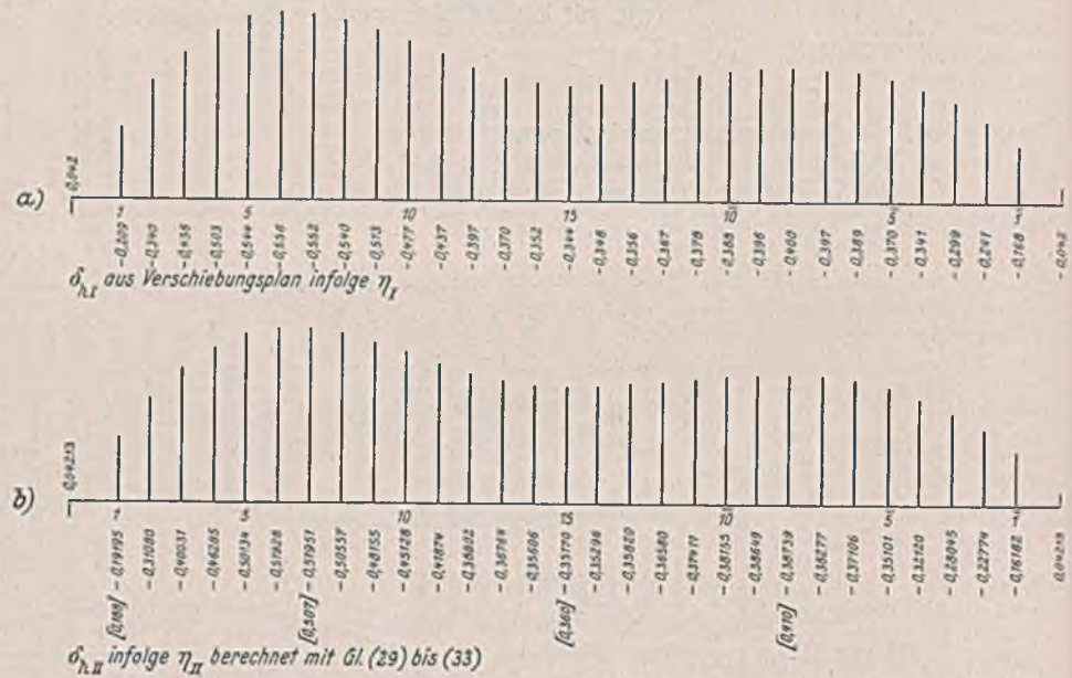
Abb. 25a u b. Waagerechte Wege der Hängeranschlüsse infolge Regelbelastung der unverteilt belasteten Kette bei t = 0^\circ .
