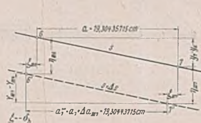
Abb. 25a u b. Waagerechte Wege der Hängeranschlüsse infolge Regelbelastung der unverteilt belasteten Kette bei t = 0^\circ .
