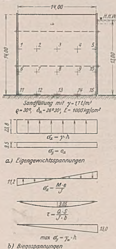
Abb. 1. Spannungen im Fangedamm.
