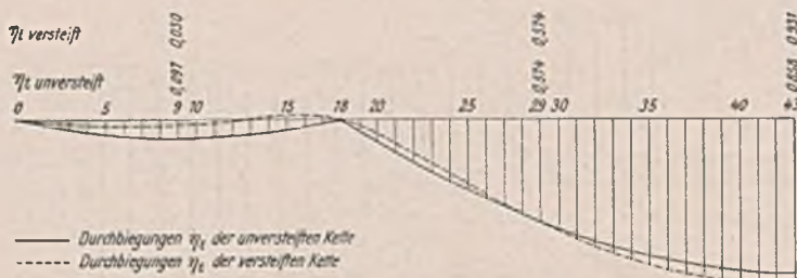
Abb. 34. Gemessene Durchbiegungen \eta_{1t} infolge einer Temperaturzunahme um t = 35^\circ der unverstärkten und der verstärkten Kette.
