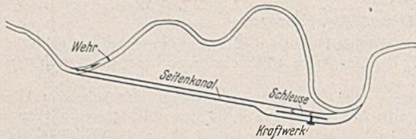
Abb. 5. Anordnung einer Staustufe mit Seitenkanal.
