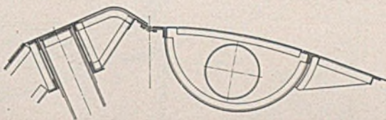
Abb. 8. Stauklappe für ein Dreigurtschütz, versteift durch einen Fischbauch.
