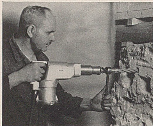
Abb. 1. Elektrohammer beim Bohren mit einem Kreuzbohrer und einem Bohreinsatzstück. Bauart Siemens.
